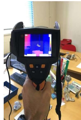
Termocamera/ Telecamera termografica Mappe di temperatura
